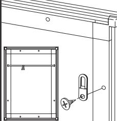
フレーム裏側の穴に吊り金具を取り付けて、ひも等で吊り下げます。
